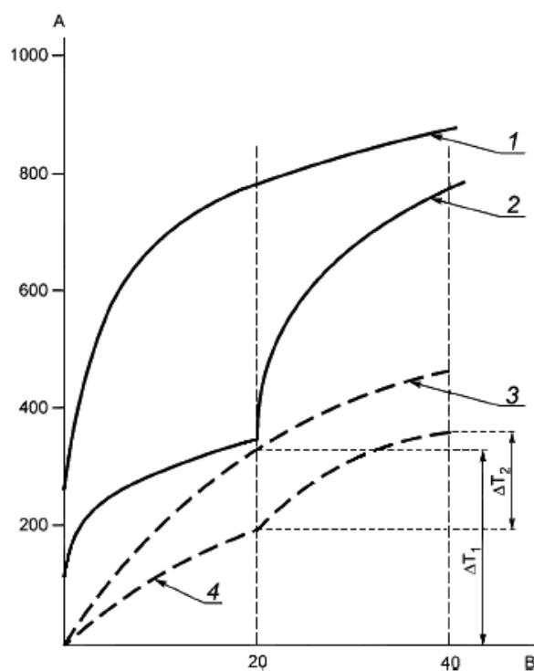
А - температура, °C; В - время, мин; 1 - стандартная температурная кривая; 2 - кривая тлеющего пожара; 3 - средняя температура на образце при воздействии по стандартной температурной кривой; 4 - средняя температура на образце при воздействии по кривой тлеющего пожара
